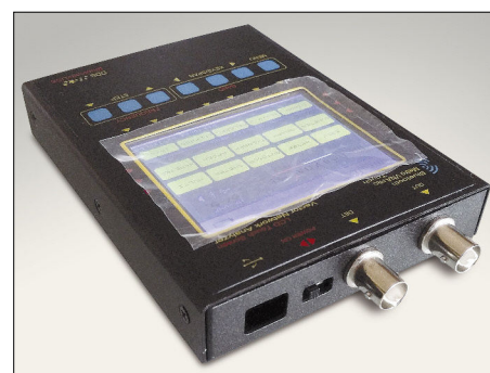
Bild 7: An der schmalen Oberkante sind die beiden BNC-Messbuchsen, die USB-Buchse und der Einschalter angeordnet.
