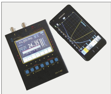
Bild 1: Ansicht des eingeschalteten Antennenanalysators MetroVNA Pro und eines externen Steuerungs- und Anzeigegeräts per Bluetooth verbundenen Android-Smartphones
