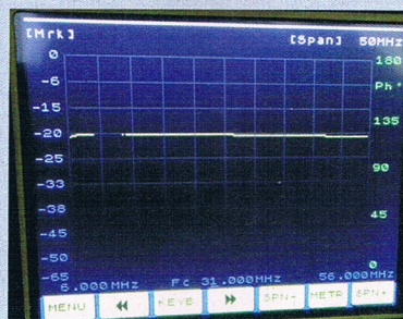
Bild 4: TLGRAPH stellt Dämpfung und Phasenwinkel über der Frequenz grafisch dar
