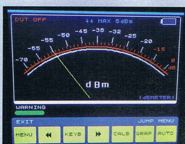
Bild 6: Das dB METER ist ein breitbandiger Feldstärkemesser
