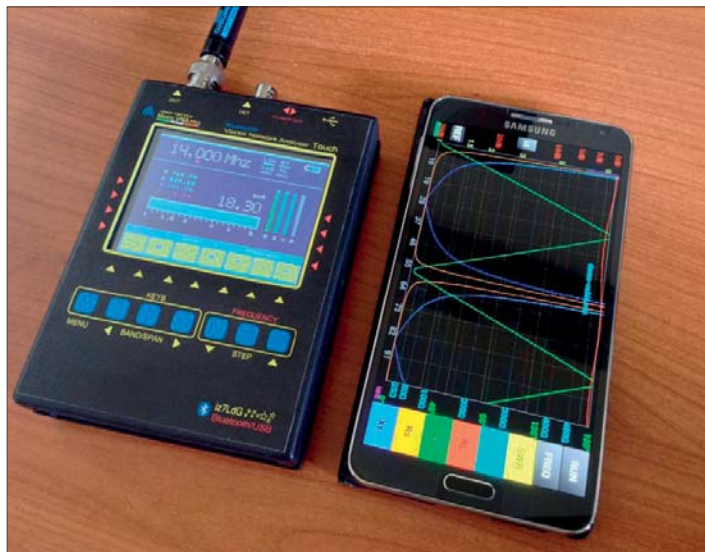
Bild 1 – MetroVNA finns i flera utföranden. Ta Deluxversionen som klarar 1–250 MHz. Här ligger en Androidtelefon vid sidan som tar upp information via blåttand.
