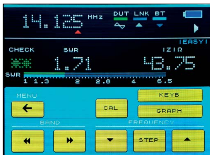
Bild 4 – EASY-menyn en snabb överblick för antennmätningar. Här ser vi att antennsystemet ger en SWR av 1,71 och en impedans av 43,75 ohm. Man kan snabbt byta band eller stega upp och ner i frekvens. Vill man se resultatet i en graf finns en knapp för det.
