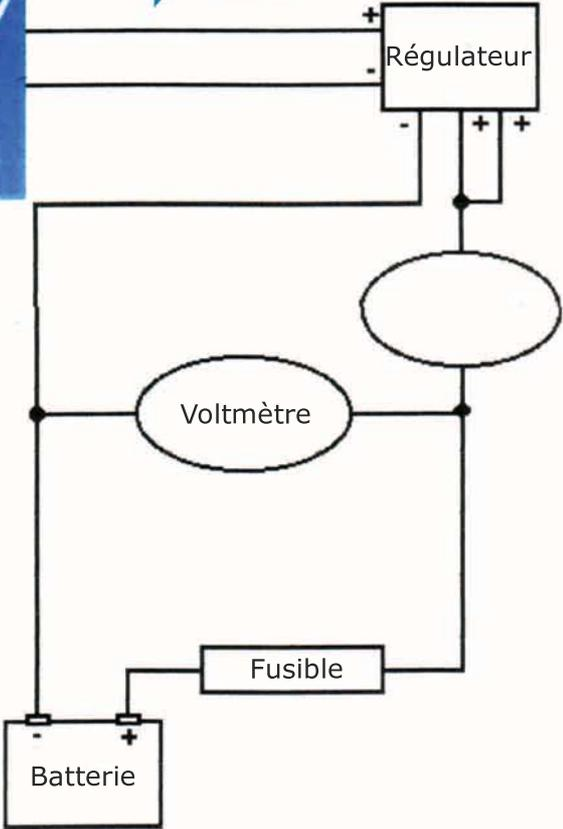
**La D400 doit toujours être connectée à la batterie lorsqu'elle fonctionne car autrement les cables de sortie génèrent un courant de forte intensité**
