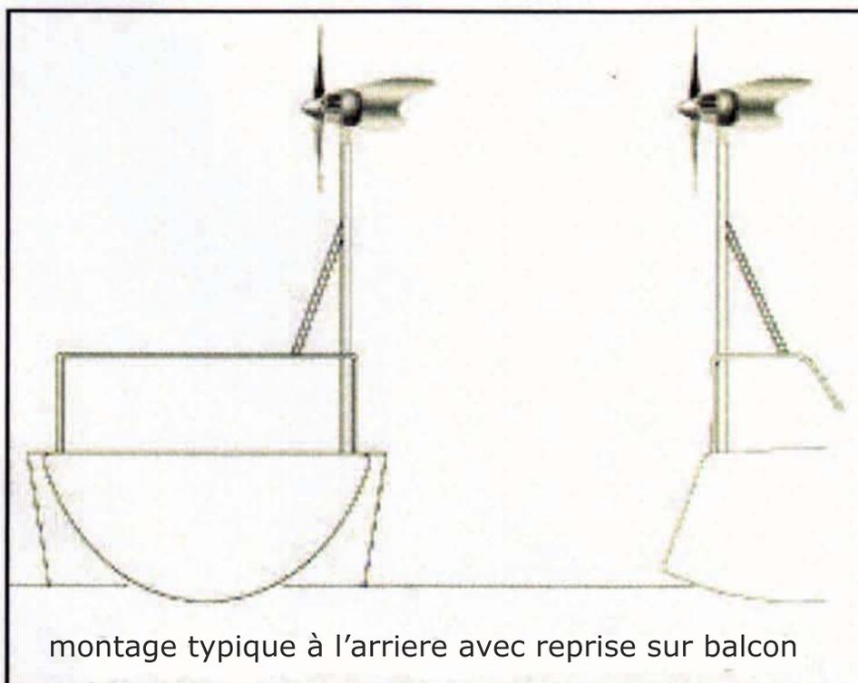
Sur les bateaux de rivières ou lorsque cette configuration est retenue, un mat rabattable sur charnière peut être utilisé. Pour les Ketchs un montage sur le mat de misaine est plus adapté.
