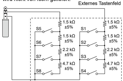
**TIPP:** Sie können zwischen einem externen Tastenfeld und einer Paddletaste oder einer geraden Taste wechseln, wenn Sie sie parallel anschließen.
