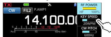
4. Drehen Sie **[MULTI]**, um die Tastgeschwindigkeit auf einen Wert zwischen 6 und 48 Wörtern pro Minute (WPM) einzustellen.
