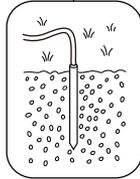
**⚠ WARNUNG! NIEMALS** die [GND]-Anschlüsse an eine Gas- oder Stromleitung anschließen, da solch eine Verbindung zu Explosionen oder elektrischen Schlägen führen kann.
