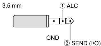
Wenn der SEND-Anschluss eine induktive Last wie z.B. ein Relais steuert, kann eine elektrisch gegenwirkende Kraft auftreten und der Transceiver kann beschädigt werden. Um dies zu verhindern, empfehlen wir die Verwendung einer Schaltdiode, wie 1SS133, auf der Lastseite der Schaltung, um solch eine gegenwirkende elektrische Kraft zu absorbieren.
