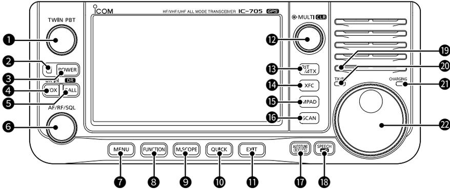
**1 PASSBAND-TUNING-STEUERUNG (TWIN PBT)**
