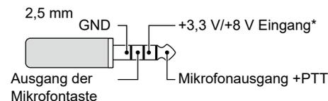
\* Sie können zwischen  $+3,3 \text{ V}$  (über  $470 \Omega$ ) und  $+8,0 \text{ V}$  (Maximum  $10 \text{ mA}$ ) auswählen
