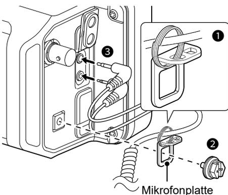
① Wenn Sie andere Geräte an den [SP/MIC]-Buchsen anschließen, bringen Sie das Kabel durch den Spaltring (nicht im Lieferumfang enthalten) an der Platte an.
