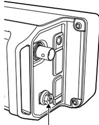
Für optimale Ergebnisse verbinden Sie einen dicken Draht oder ein Leiterband mit einem langen Erdungsstab. Halten Sie den Abstand zwischen dem [GND]-Anschluss und der Erde so kurz wie möglich.
