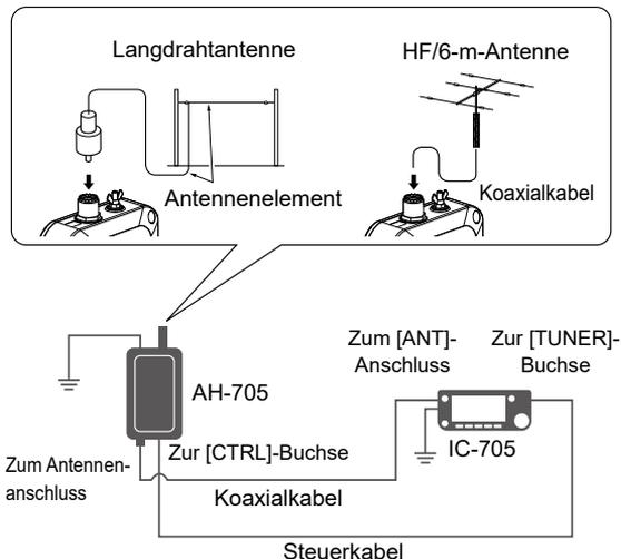
**⚠ ACHTUNG HOCHSPANNUNG! NIEMALS** das Antennenelement während des Abstimmens oder Sendens berühren. Das Antennenelement immer an einem sicheren Ort aufstellen.
