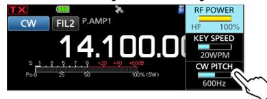
4. Drehen Sie **[MULTI]**, um den CW-Pitch auf einen Wert zwischen 300 und 900 Hz (in 5-Hz-Schritten) einzustellen.
