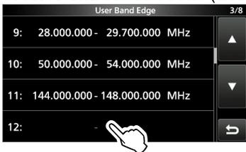
3. Inserire la frequenza del limite banda inferiore, quindi toccare [ENT]. (Esempio: 433.)
