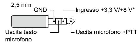
\* È possibile selezionare tra +3,3 V (tramite 470 Ω) e +8,0 V (massimo 10 mA)
