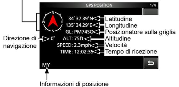
① Quando "GPS Select" è impostato su "Manual", SPEED, Bussola e Direzione bussola non vengono visualizzati.
