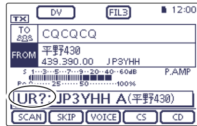
山かけ通信で、平野430のレピータに送信し、正常に電波が届いた状態
