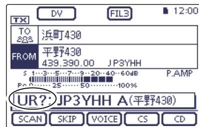
ゲートウェイ通信で、平野430のレピータから、浜町430のレピータに送信し、正常に電波が届いた状態
