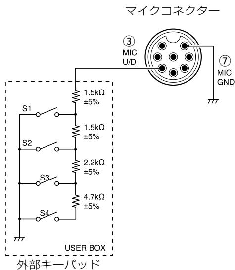
マイクコネクターに制御回路(外部キーパッド)を付加することにより、機器外部からCWメモリーキーヤー(M1～M4)、送信用ボイスメモリー(T1～T4)の送出を制御することができます。
