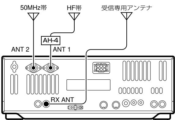
すべてのアンテナコネクターにアンテナを接続できるが、アンテナは手動切り替えになります。
