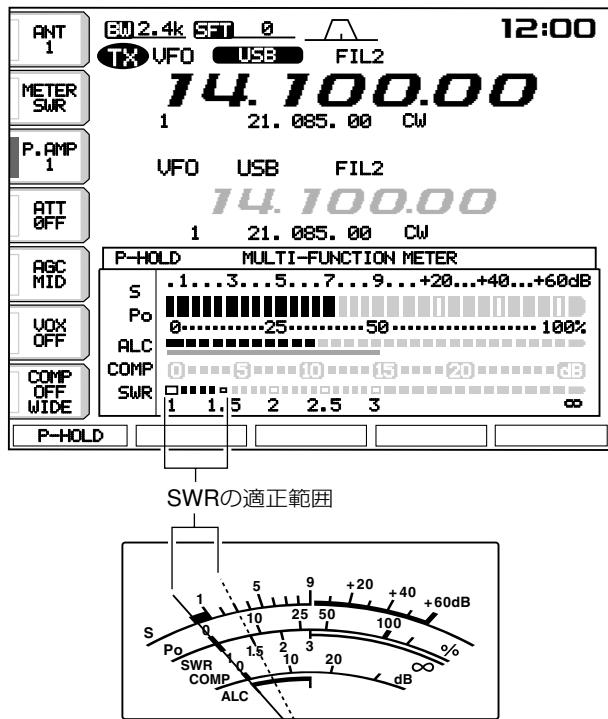
本機はSSBモードのように、常に変動するような送信出力でも、安定した測定結果がリアルタイムで得られるSWR測定回路を採用し、従来までのセット操作が不要になりました。
