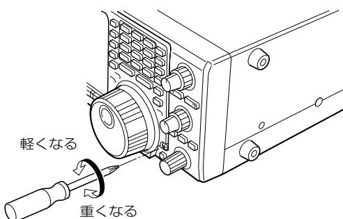
メインダイヤルを回転させるときのトルク(重さ)をお好みに合わせて調整できます。
