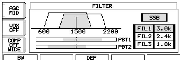
本機には、DSPのフィルタリングによるデジタルツインPBTを搭載しています。
