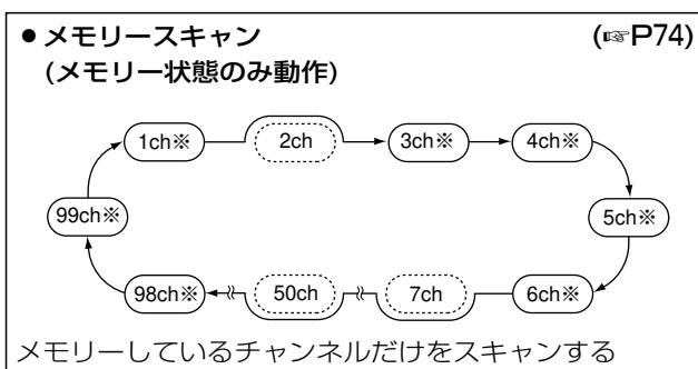
本機のスキャンは、VFO状態で動作するプログラムスキャン、メモリー状態で動作するメモリースキャンとセレクトメモリースキャン、VFOおよびメモリー状態で動作する△Fスキャンがあります。
