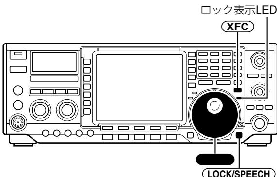
クイックスプリット機能とは、スプリット機能を“ON”にすると同時に、SUB VFOの運用モードと周波数も同時に設定する機能です。
