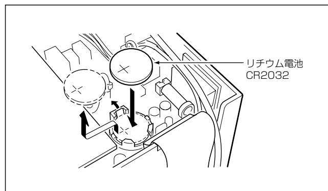
本機の時計機能をバックアップするため、リチウム電池を使用しています。
