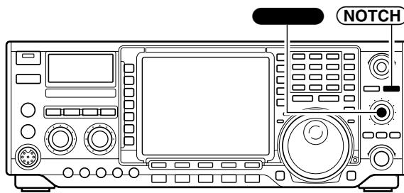
チューニング電波やCW信号のような単信号の混信を除去するのに効果を発揮します。
