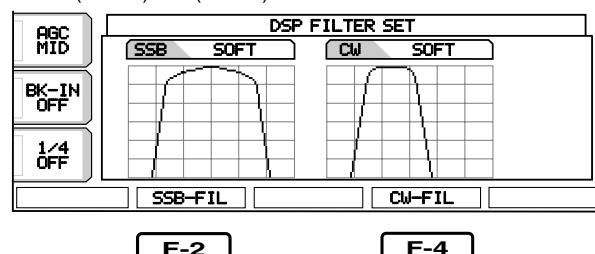
SSB用フィルターの特性をなめらかにし、CW用フィルターのスカート特性をブロードにしたタイプです。
