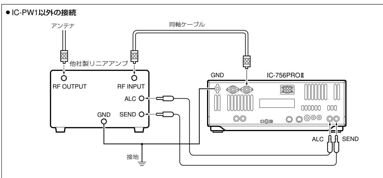
(注1)SEND(送受信切り替え回路)端子のリレー接点容量は、DC16V/0.5A以下です。
