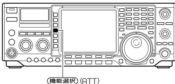
アッテネーター(減衰器)は、強い信号を受信したときに減衰して受信音のひずみを低減します。
