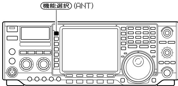
本機のアンテナコネクターはHF/50MHz帯用のANT1とANT2、受信専用のRX ANTコネクターの3系統あります。
