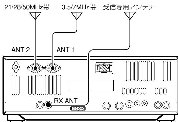
すべてのアンテナコネクターにアンテナを接続でき、バンドを切り替えるだけでアンテナを自動制御します。
