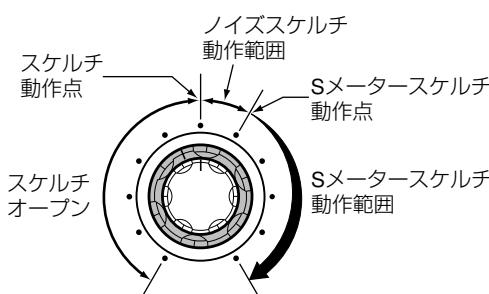
すべての運用モードで動作しますが、スケルチ動作は次のようにになります。
