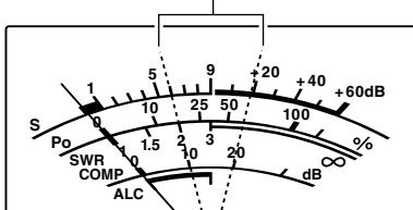
受信時はSメーターとして動作し、受信した信号の強度を表示します。
