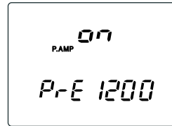
AG-1200用DC電圧を印可する(初期設定)
