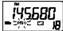
Mientras se está en pausa en un canal de memoria o de llamada « PRIO » destella.
