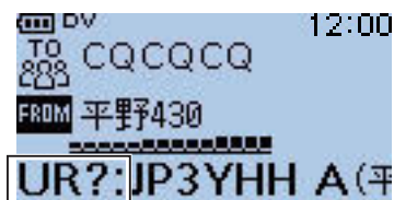
山掛け通信で、平野430のレピータに送信し、正常に電波が届いた状態
