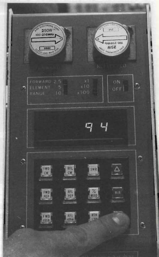
figura 4 - Potenza PEP sviluppata (su carico fittizio) in banda 2 m.
