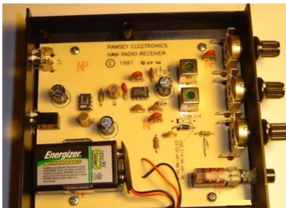
Le kit RAMSEY de ce récepteur HR DC 40 m est articulé autour d'un circuit mélangeur à grand gain (17dB) NE- 602.
