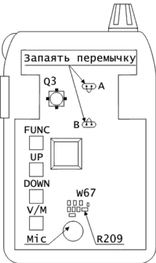
1. Чтобы раскрыть диапазон частот, следует удалить R209. При нажатых кнопках "FUNE" и "V/M" включить питание.
