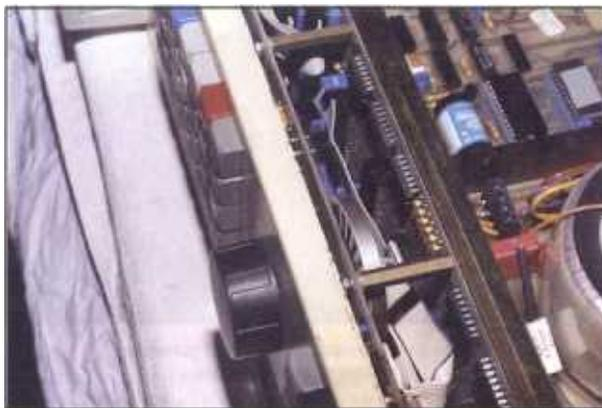
Foto 2 - Particolare dell'Encoder optoelettronico e della pila di back-up al litio
