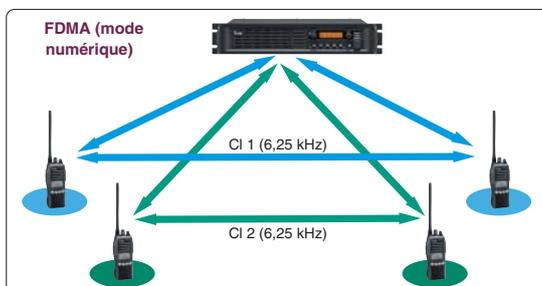
• Le système FDMA double toujours la capacité, aussi bien en mode 'peer to peer' que via un relais.
