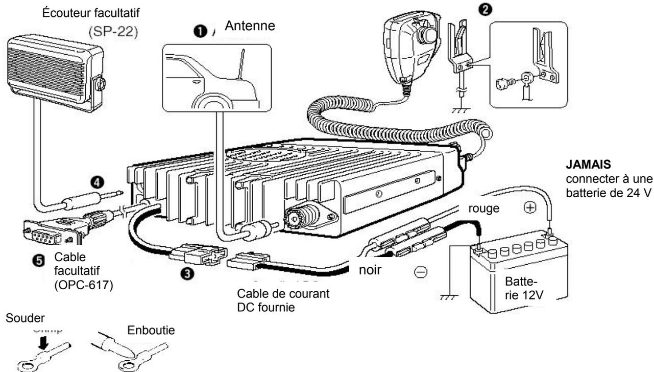
**NOTE :** Utiliser le terminal montrer ci-dessous pour les connections de cable.
