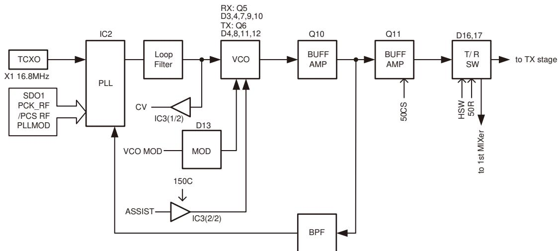
Fig. 6 PLL circuit
