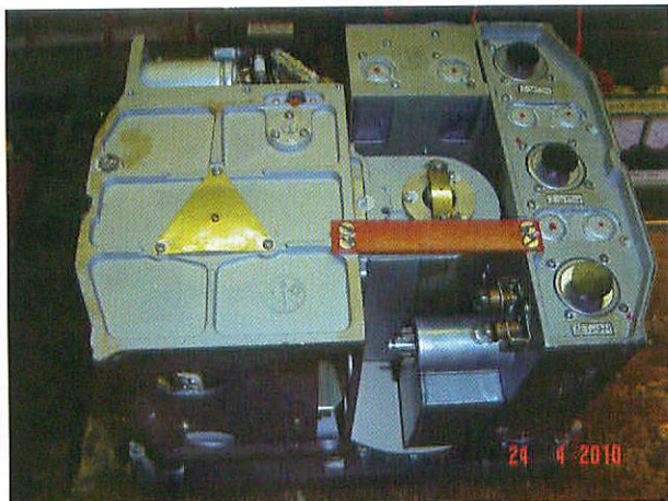
Lato posteriore. Notare le valvole, le lampade e la valvola di scorta
