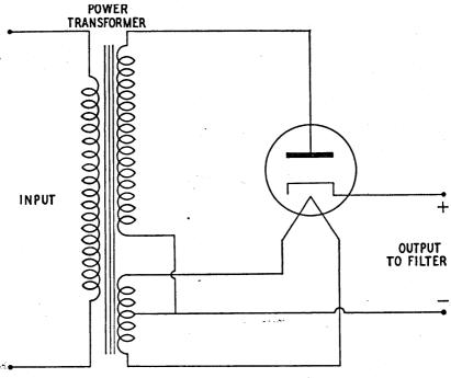
FIGURE 19. Half-wave rectifier.
