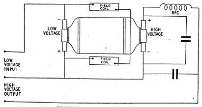
FIGURE 17. Dynamotor circuit.
