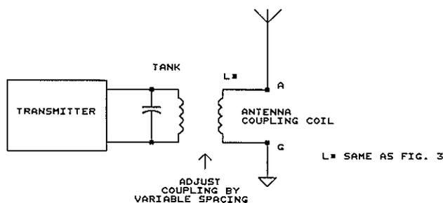
**FIGURE 4 AN EASIER WAY TO COUPLE ANTENNA**
