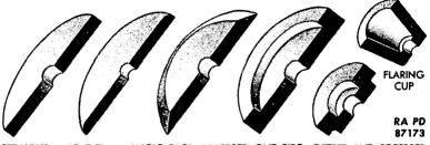
BEVELED ANGLE FACE RECESSED ONE SIDE OFFSET AND RECESSED STRAIGHT
