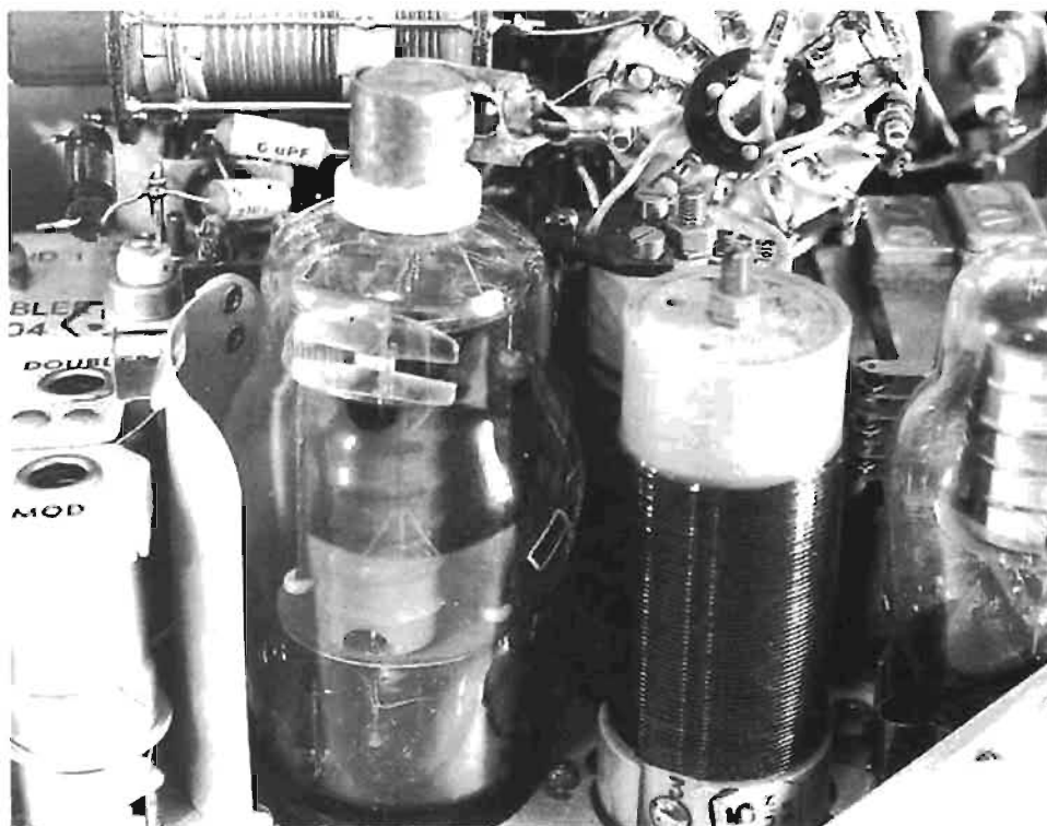
Fig. 9. — L'étage de puissance et la 2E22
