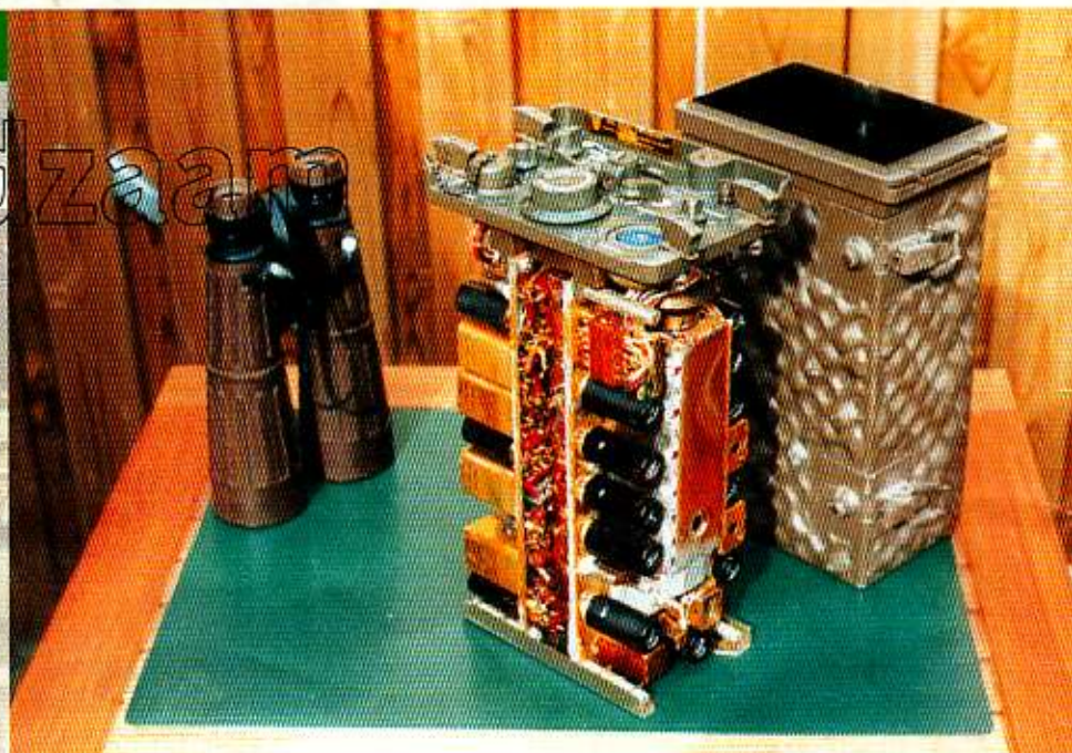
De legertransceiver RT-70 uit de behuizing.
