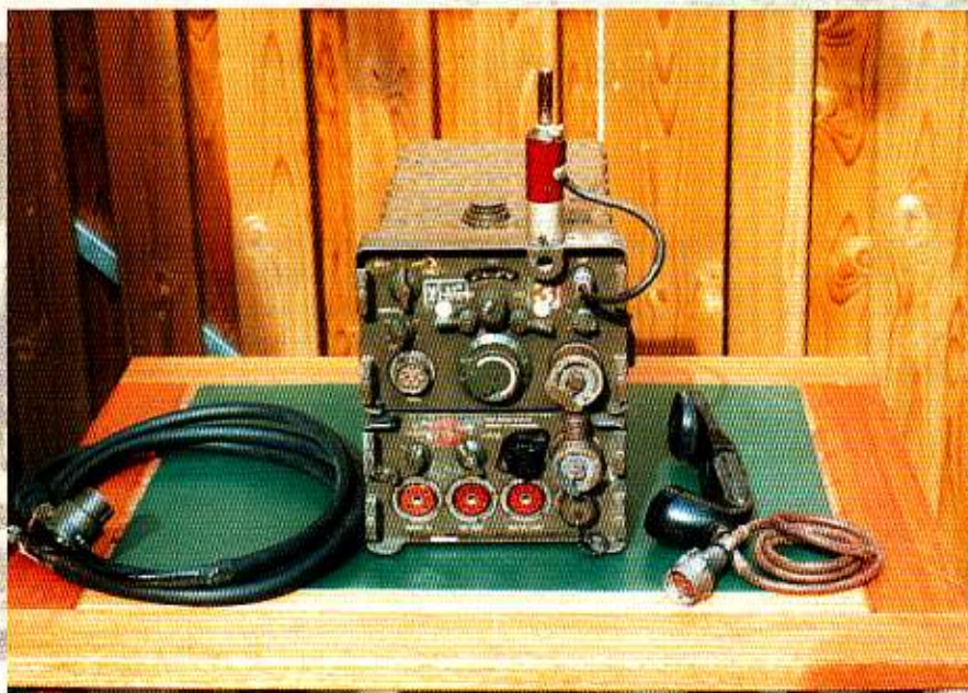
De transceiver met daaronder de AM-65, inclusief telemike en voedingskabel.
