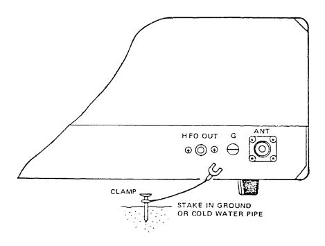
FIGURE 1-4 INSTALLATION OF GROUND
