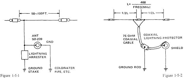
FIGURE 1-5 TYPICAL ANTENNA INSTALLATION
