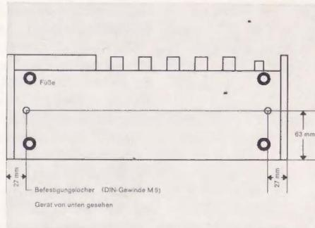
Sollte es erforderlich sein, das Gerät auf einem Untersatz stabil zu befestigen, ist folgendes zu beachten: Auf der Unterseite des Gerätes befinden sich zwei Gewindebuchsen für Schrauben mit dem Gewinde M5. Diese Buchsen liegen 63 mm von der Rückwand und 27 mm von den Seitenteilen nach innen. Sie sind durch den Bezug, der herauszuschneiden ist, verdeckt.
