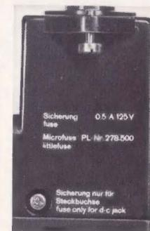
Nach einem eventuellen Kurzschluß im Verbraucher muß bei Betrieb mit 6...12 V Außenbatterie die Sicherung in der Oberseite (über dem Netzschalter) ausgetauscht werden. Dazu Netzteil aus dem T 1000 herausnehmen und Sicherung auswechseln. Hierfür folgende Sicherungen verwenden: «micro-fuse» PL Nr. 278 500; 0,5 A 125 V, der Firma Wickmann oder der Firma Littlefuse Incorporated, Illinois, USA.
