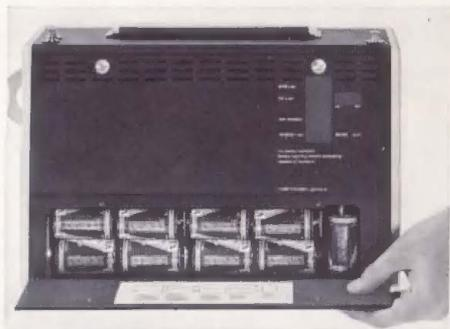
Für die Batteriespeisung sind 8 Monozellen von je 1,5 Volt erforderlich (Größe D; internationale Bezeichnung R 20; beispielsweise: Pertrix 222; für besondere Anforderungen an Lebensdauer: Mallory MN 1300). Eine zusätzliche, neunte Batterie dient zur Skalenbeleuchtung; für den Betrieb des Gerätes ist sie entbehrlich.
