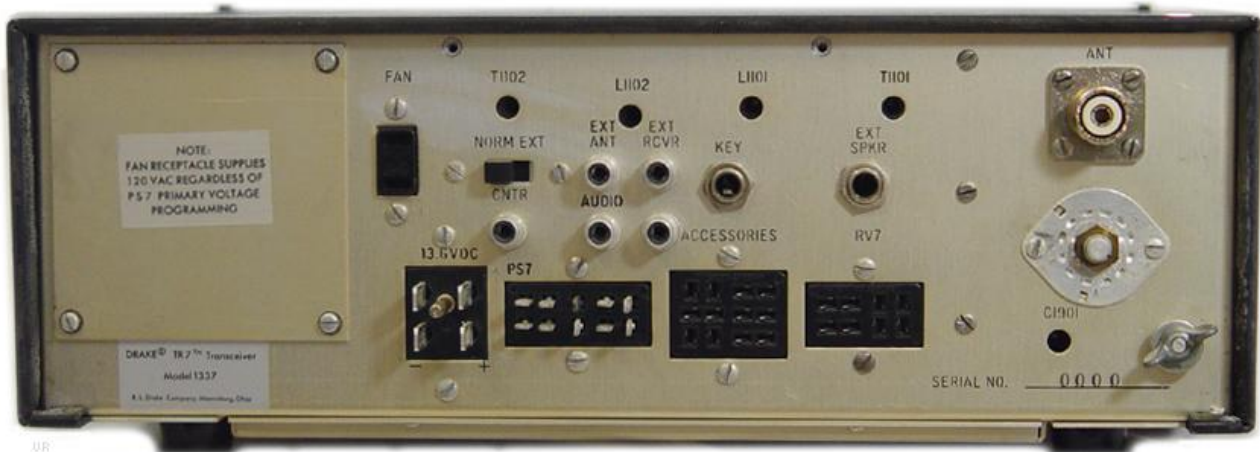
Figura 2-2 Panel posterior TR-7
