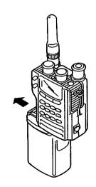
②既に、無線機に取り付けられている CMU 160/CMU161 を外します。図のように、CMU160/CMU161 の丸穴にピンセットの 先を軽く入れ、引き出してください。
