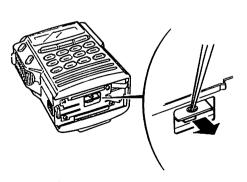
③無線機に CMU160/CMU161 を差し込みます。図のように、部品が取り付けられていない面(裏面)を上にし、真っ直ぐ差し込んでください。
