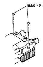
[7]②で外したネジで電極を取り付けます。
