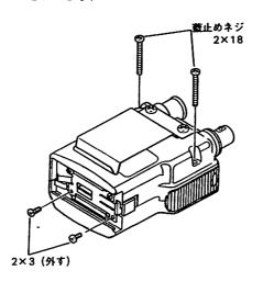
[4]操作面(表示部が見える側)を上にし、操 作面のケースを持ち、ゆっくり右に開き ます。
