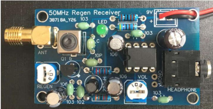
本機は 50MHz 10mW AM 送信機とセットになる受信機です。同じサイズのボードで、電源電圧も同じ 9V です。シールドコイルにより組み立てが簡単で、安定した性能が得られます。電源電流は約 8mA、受信感度は約-100dBm です。
