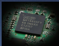
Dual Core 32bit 浮動小数点 高速DSP
