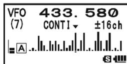
Les sélections disponibles sont les canaux  $\pm 5$ ,  $\pm 9$ ,  $\pm 16$ ,  $\pm 24$ , et  $\pm 50$  (par défaut: les canaux  $\pm 16$ ). La bande passante visible, cependant, dépend de la taille du pas du canal sélectionné, donc concordez les pas du canal par défaut avec la bande amateur que vous utilisez.
